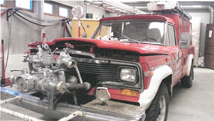
Bilde 2. Panseret kan ikke lukkes helt igjen grunnet tilpassing av radiator. Det er vanskelig å få tak i deler til en så gammel bil (2015).
